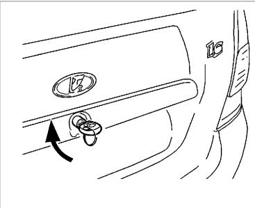
Рис. 25. Открывание багажника
