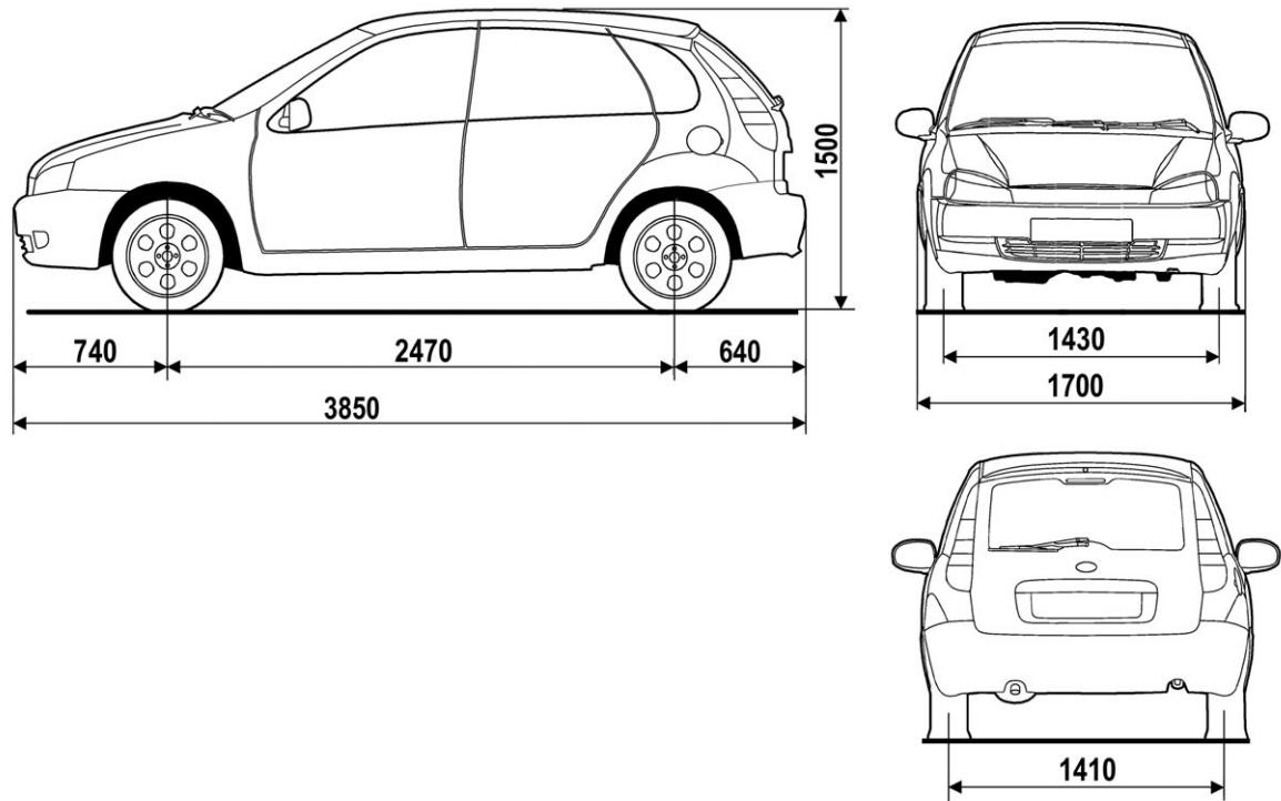
Рис. 58б. Габаритные (справочные) размеры автомобиля ВАЗ-11193 и его модификаций
