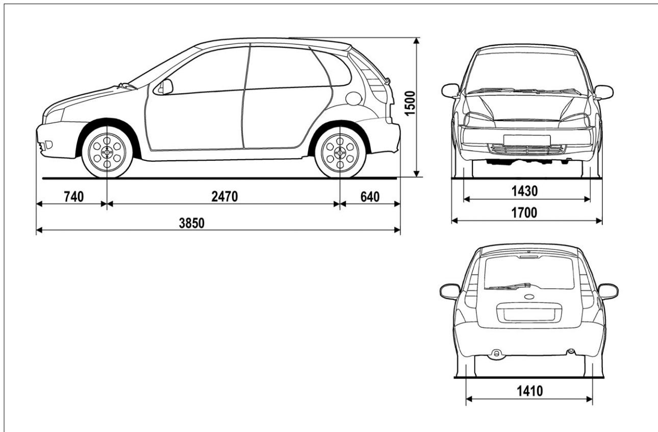
Рис. 586. Габаритные (справочные) размеры автомобиля ВАЗ-11193 и его модификаций
