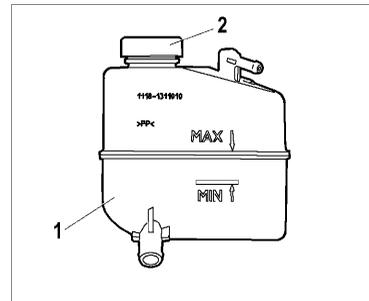
Рис. 42. Расширительный бачок
