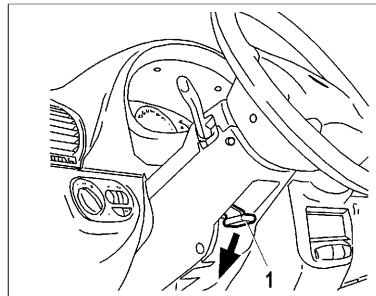
**Рис. 12. Регулировка положения рулевого колеса**
