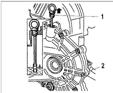
Рис. 41. Проверка уровня масла в коробке передач
