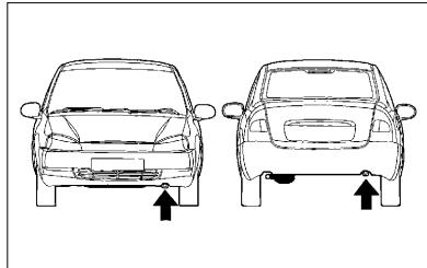
**Рис. 39. Проушины для буксировки**
