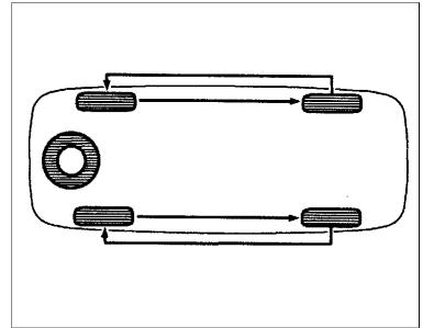
Рис. 46. Схема перестановки колес
