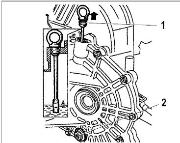
Рис. 41. Проверка уровня масла в коробке передач
