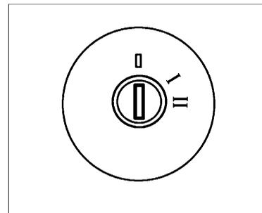
**Рис. 34. Выключатель зажигания**
