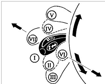
Рис. 32. Рычаг переключателя световой сигнализации
