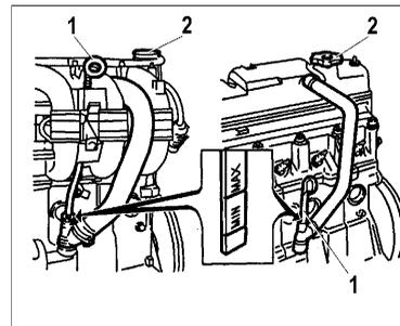
Рис. 40. Проверка уровня масла в картере двигателя
