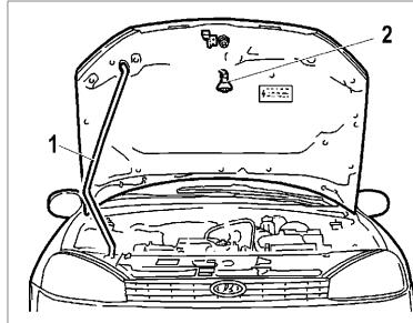
Рис. 24. Открывание капота
