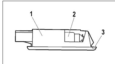
**Рис. 57. Плафон освещения багажника**
