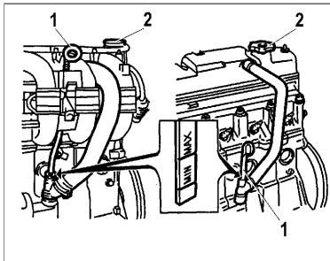
Рис. 40. Проверка уровня масла в картере двигателя
