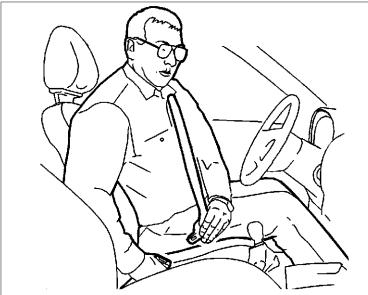
Рис. 13. Вытягивание ремня безопасности
