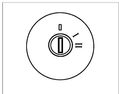
**Рис. 34. Выключатель зажигания**
