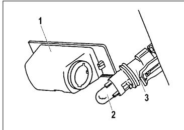
**Рис. 54. Фонарь освещения номерного знака**
