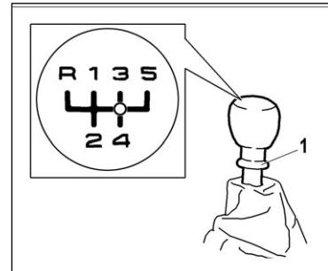
**Рис. 35. Рычаг переключения передач**
