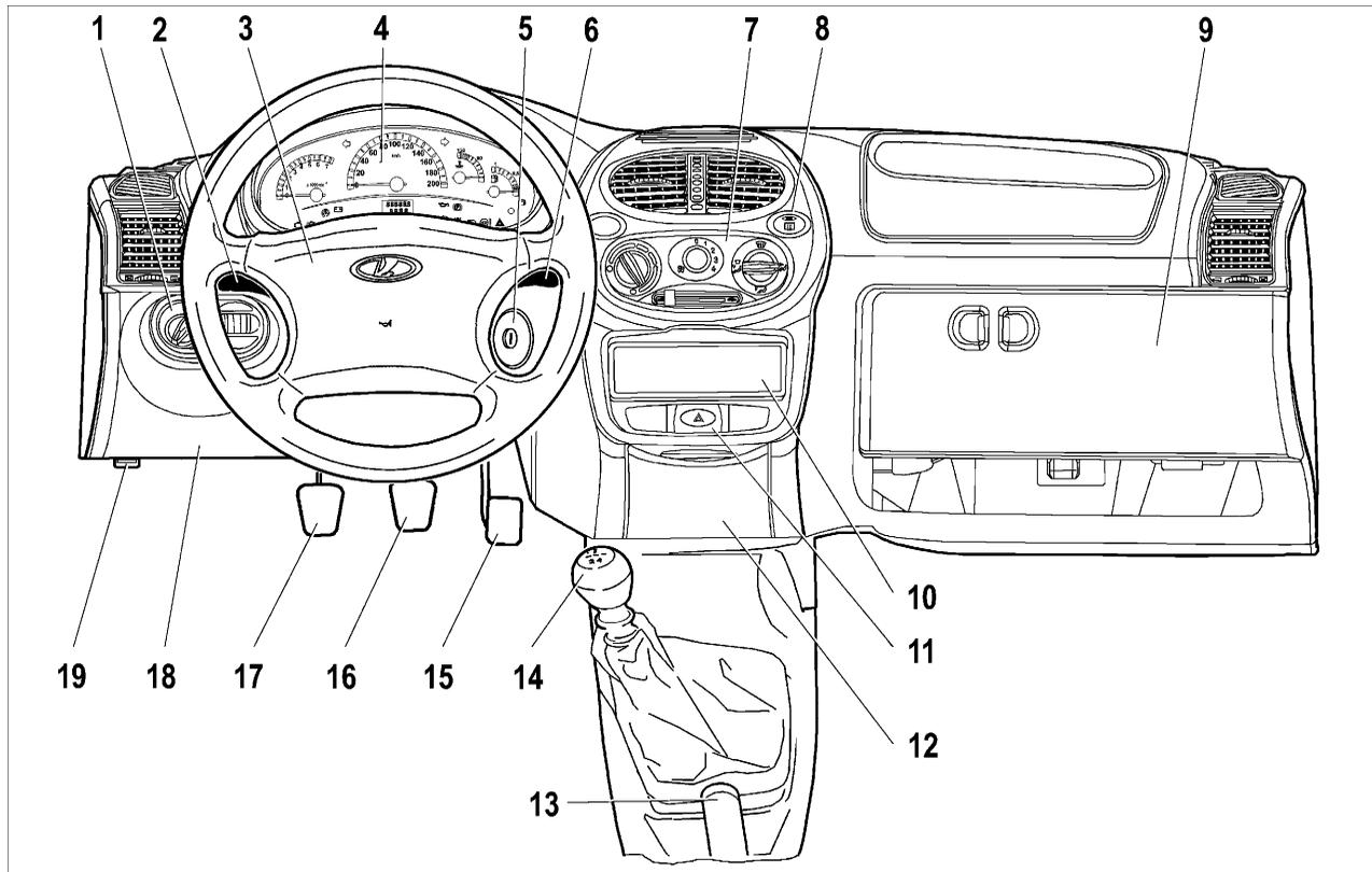
Рис. 28. Панель приборов
