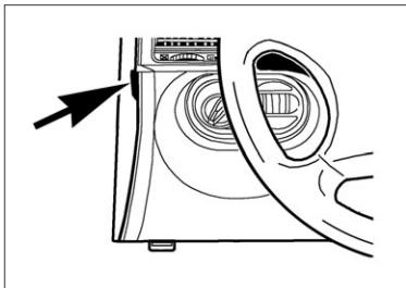
Рис. 50. Открывание монтажного блока
