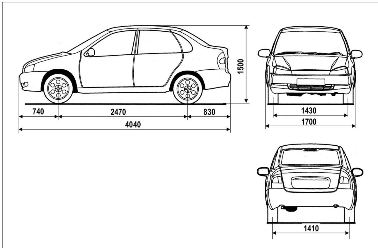
Рис. 58а. Габаритные (справочные) размеры автомобиля ВАЗ-11183 и его модификаций
