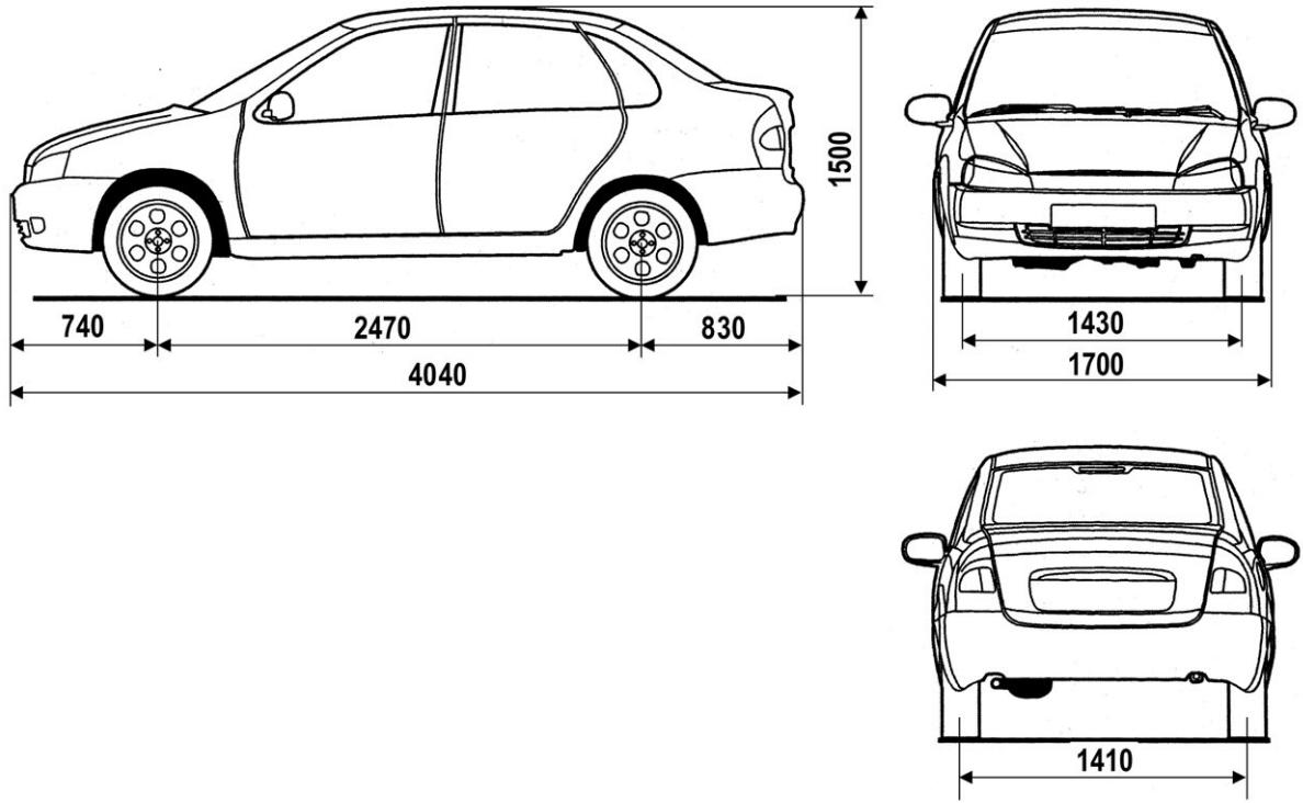
Рис. 58а. Габаритные (справочные) размеры автомобиля ВАЗ-11183 и его модификаций
